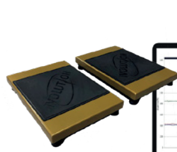
VT 6.0 BALANCE Conectado a dos plataformas de fuerza (derecha/izquierda) realiza mediciones y retroalimentación en tiempo real, lo que permite la visualización y comparación de resultados; generación de reportes y base de datos de atletas. Información recolectada: - Fuerza máxima en la fase concéntrica (despege). - Tiempo de vuelo - Tiempo total de salto - Tiempo de fase concéntrica y excéntrica - Altura de Salto.
