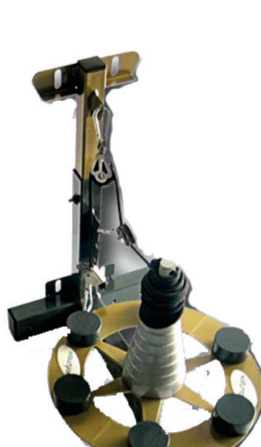
POLEA CÓNICA DESMONTABLE Dispositivo Inercial, de eje variable. El dispositivo más versátil dentro de los que tienen esta característica. Para regular la intensidad del dispositivo, se puede agregar o quitar pesas al disco que genera la inercia. Como así también podemos alterar el radio del eje donde se irá enrollando la soga. A diferencia de la polea anterior, este dispositivo es completamente desarmable (lo que permite mayor facilidad en el transporte), pero no incluye las columnas verticales.
