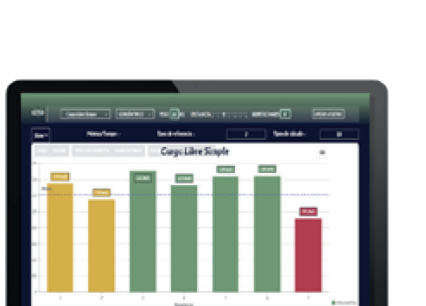
VT 6.0 LIBRE Medida directa de la velocidad de una carga externa para obtener valores de la fuerza, la aceleración, la potencia de todo movimiento, así como la medida directamente. / Permite estar conectado al Valkyria trainer, por cable o bluetooth, para ver las curvas de fuerza en función del tiempo, con todos los detalles del mismo.
