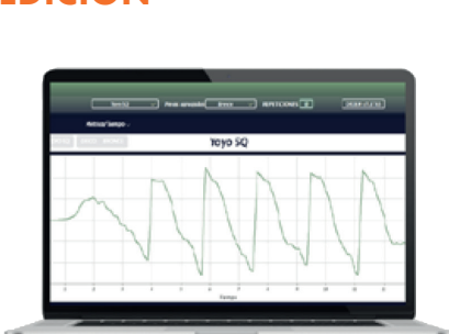
VT 6.0 YOYO Procesar información adquirida en tiempo real por encoder conectado a equipos inerciales. Ofrece gráficos de variables como velocidad, aceleración, fuerza, potencia. Equipos compatibles: Yoyo Squat-X Tend, Aeryo Yoyo, Sillón Camilla, Remo Prensa, Hip Thrust Inercial.
